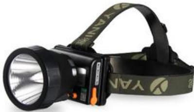
CREE 光源；锂电池，续航时间超强光 $\geq 10$  小时，强光 $\geq 15$  小时，普光 $\geq 60$  小时；亮度 $\geq 300W$  白炽灯，能耗要求 $\leq 8W$ led 能耗；射程要求 350 米（清晰）-800 米以上（可见信号灯）；75MM 铝合金光杯（亮度增强 180%）；头灯重量 $\leq 0.25kg$ ，IP65 防水等级（用水冲洗无任何伤害）；三档调光（超强光、强光、普光）
